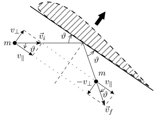
Per studiare l'effetto dell'angolo d'attacco, consideriamo l'urto di una "particella di aria" di massa  $m$  e velocità  $\vec{v}_i$  contro l'ala dell'aereo, supposta ferma (come nella precedente discussione); vedi figura a fianco. Rispetto ad un sistema di coordinate con un asse parallelo all'ala ed uno perpendicolare (entrante) a questa, le componenti di questa velocità possono essere scritte come:
