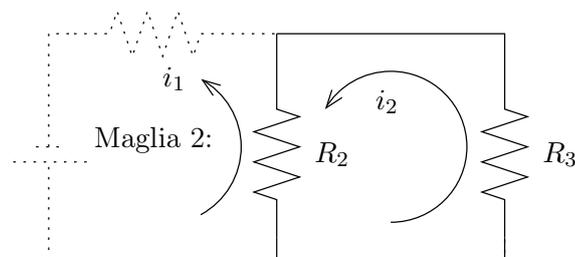
Alternativamente, poteva esser scelta come seconda maglia la linea chiusa esterna contenente il generatore di tensione,  $R_1$ ,  $R_3$ , ed il filo in basso. Poiché tutti i componenti presenti nel circuito sono già contenuti in una delle precedenti due maglie, è superfluo includere anche quest'ultima.
