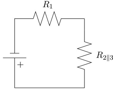
dove  $R_{2\parallel 3}$  è la *resistenza equivalente* al parallelo di  $R_2$  e  $R_3$ . Per trovare il suo valore basta applicare il fatto che le correnti che attraversano  $R_2$  ed  $R_3$ , rispettivamente  $i_2$  ed  $i_3$ , si ricongiungono ai due nodi ai quali sono attaccate le resistenze, ossia:
