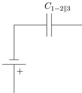
Inoltre, essendo il circuito globalmente neutro, le cariche che si troveranno su ciascuna armatura saranno (in modulo) le stesse:  $Q$ . Sfruttando queste considerazioni possiamo quindi ottenere la capacità equivalente alla serie di  $C_1$  e  $C_{2\parallel 3}$ :
