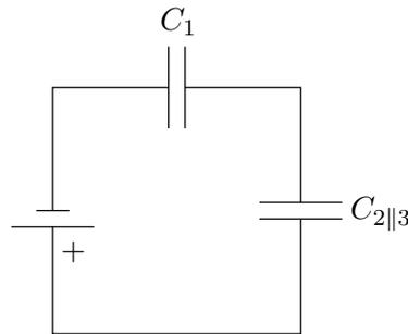
dove  $C_{2||3}$  è la *capacità equivalente* al parallelo di  $C_2$  e  $C_3$ . Per trovare il suo valore, basta osservare che la carica totale immagazzinata dai due è la somma delle cariche sui singoli condensatori, e quindi:
