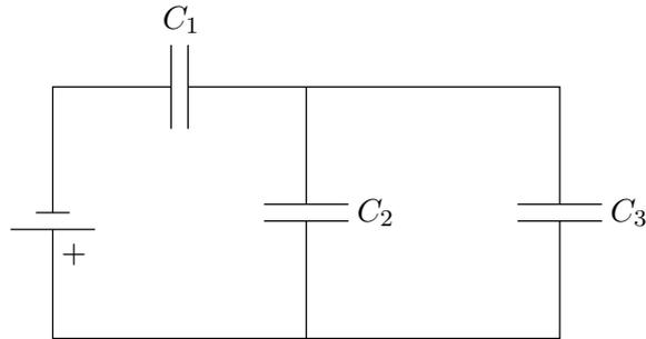
Soluzione: Per risolvere il circuito basta osservare che li condensatori  $C_2$  e  $C_3$  sono posti in *parallelo*, ossia la tensione ai loro capi è la stessa. Quindi il circuito equivalente a quello mostrato in alto è il seguente:
