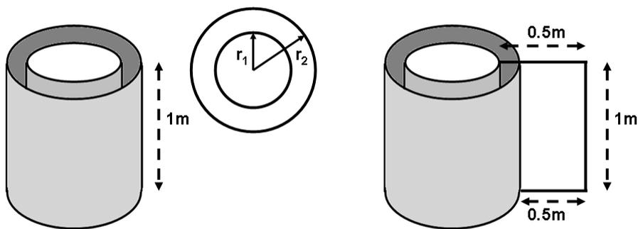
Un condensatore cilindrico che può essere considerato ideale, è formato da due armature concentriche di raggi  $r_1 = 2\text{mm}$  e  $r_2 = 4\text{mm}$ . Nell'ipotesi che la differenza di potenziale  $\Delta V$  tra le due armature sia di 50V si calcoli:
