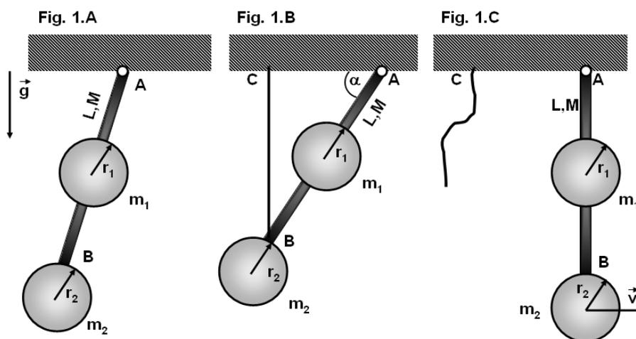
Si supponga, ora, di fissare il punto B al punto C tramite una fune inestensibile tale che l'angolo  $\alpha$  sia di  $\frac{\pi}{4}\text{rad}$  (fig. 1.B). Si calcoli:
