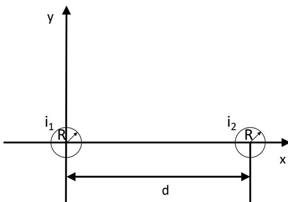
Consideriamo due fili di materiale conduttore paralleli, di raggio  $R$ , posti nel vuoto, con gli assi distanti  $d$  e percorsi dalla stessa corrente  $i_1 = i_2 = i$  in direzione dell'asse  $z$  (vedi figura) e con lo stesso verso (ortogonale e uscente dal foglio). Assumendo l'asse  $x$  come indicato in figura:
