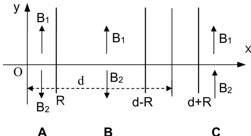
Le linee di campo magnetico per un filo percorso da corrente sono delle circonferenze con centro sull'asse del filo (parallelo all'asse  $z$  per i fili di questo esercizio, non indicato in figura e uscente dal foglio) e parallele al piano ortogonale al filo ( $x,y$ , per i due fili dell'esercizio). Per la regola della mano destra il verso delle linee di campo per i fili di questo esercizio è antiorario rispetto all'asse  $z$ .
