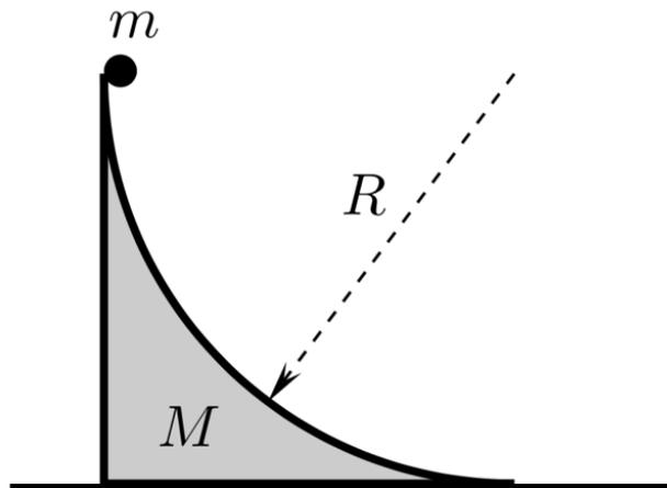
Un punto materiale di massa  $m$  è inizialmente fermo sulla cima di di una guida liscia con profilo circolare di raggio  $R$  (vedi figura). La guida, di massa  $M$ , anch'essa inizialmente ferma, può scivolare su di un piano orizzontale privo di attrito. Al tempo  $t = 0$  il punto materiale viene lasciato libero.
