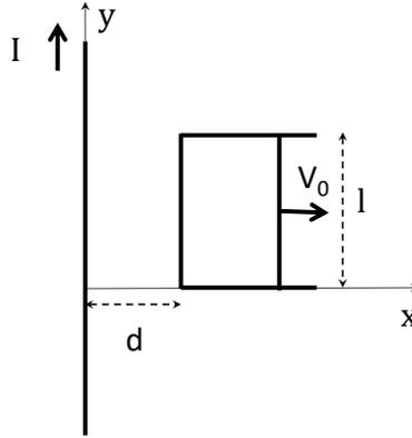
1. Il problema ha simmetria cilindrica, dunque le linee di forza del campo magnetico sono delle circonferenze con centro sull'asse y e parallele al piano x,z (l'asse z non indicato in figura è uscente dal foglio). Per la regola della mano destra il verso delle linee di campo è antiorario rispetto all'asse y. L'espressione del modulo del campo magnetico nella superficie della spira si ottiene applicando il Teorema di Ampere ad una linea di campo circolare di raggio generico  $r = x'$
