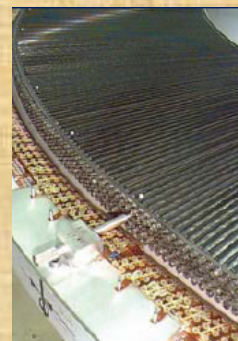
"Straw tubes" a gas proporzionali usati da ATLAS
