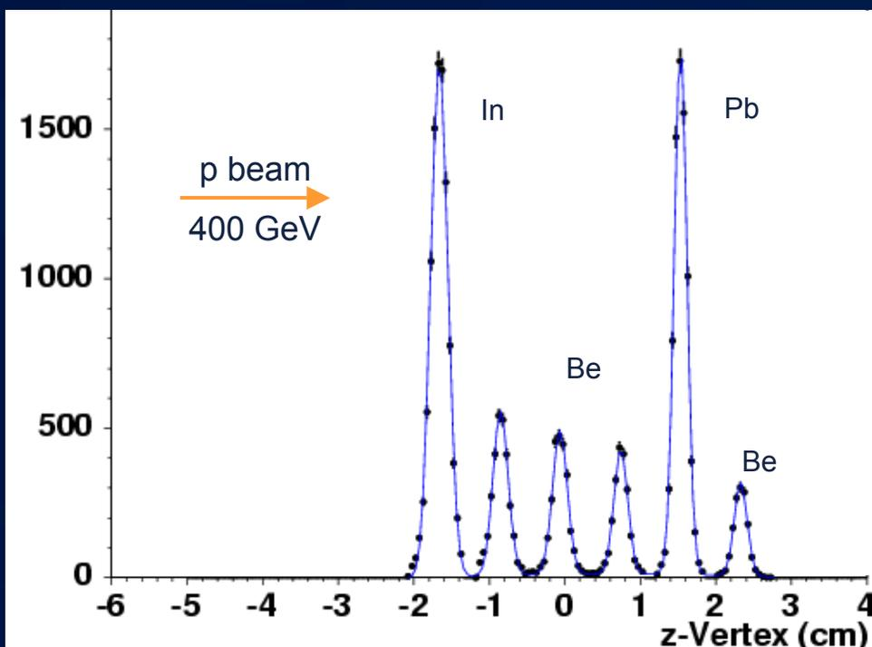
Z-vertex resolution  $\sim 600\text{--}900\ \mu\text{m}$
